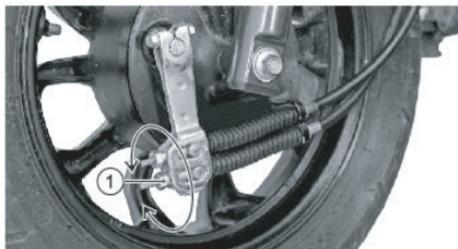
6. Después de ajustar la parte superior de la tuerca de ajuste, si se observa algún espacio libre entre la bala parte inferior (5) y la parte inferior de la ranura (6) marcada “I” como se muestra, luego gire la tuerca de ajuste (2) en sentido antihorario hasta que no haya espacio libre.
