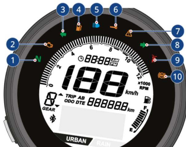
El indicador parpadea cuando el combustible alcanza el nivel mínimo o cuando hay un problema en el sensor de combustible.
